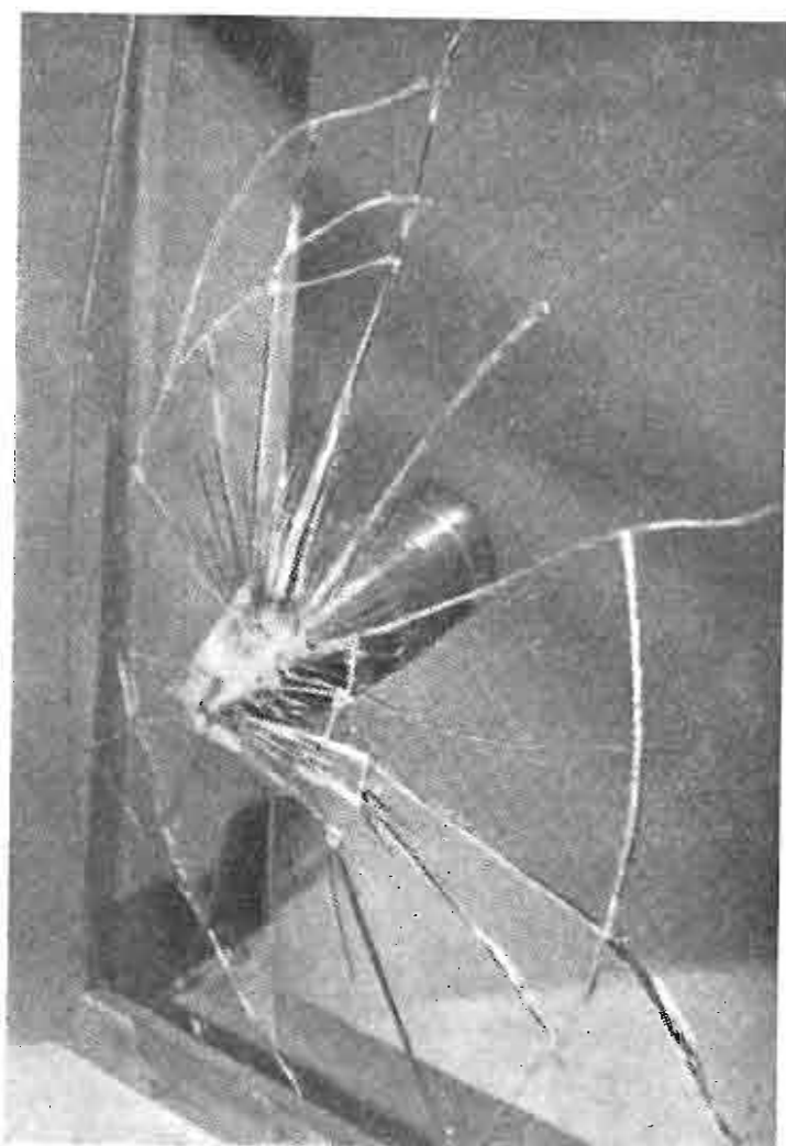
Un proiettile da 20 mm. mentre infrange una lastra di vetro fotografato mediante il microflash.
