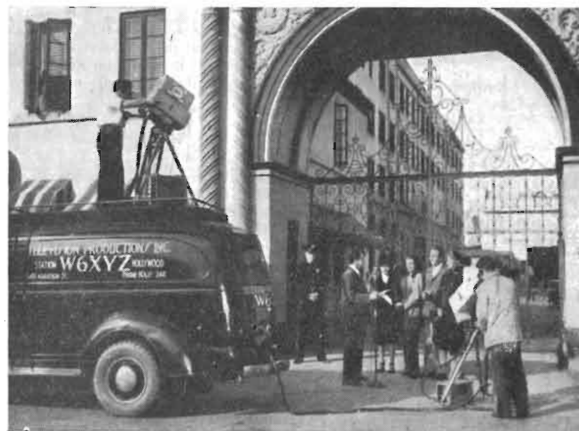
La stazione W6XYZ è attrezzata per riprese all'aperto; qui un reporter intervista alcune attrici cinematografiche all'uscita degli stabilimenti Paramount. Il collegamento con gli studi è effettuato mediante un radio-link.
